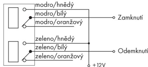
**Ovládání centrálního zamykání minusovým impulzem**
