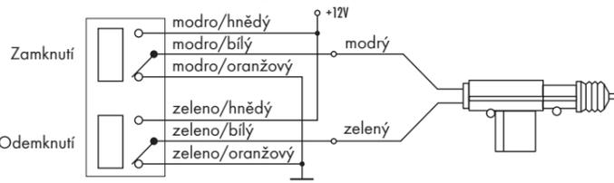
**Ovládání centrálního zamykání plusovým impulzem**
